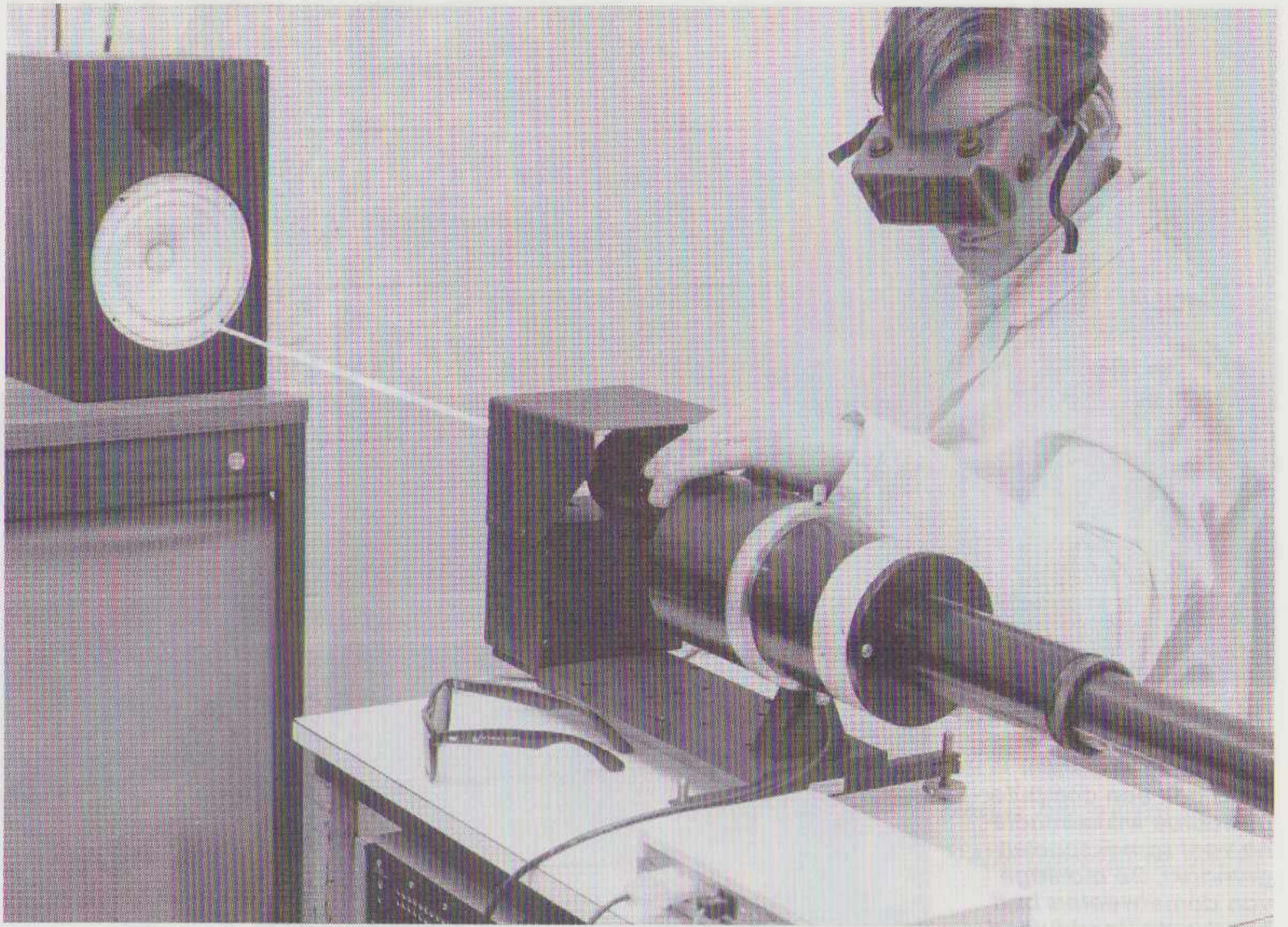
De meting van het conusgedrag door middel van een laserbeam.
